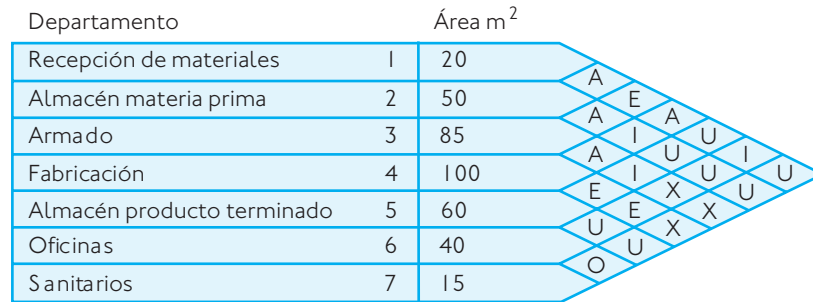
Figura 3.12 Matriz diagonal (diagrama de correlación) que se utiliza en el método SLP.
