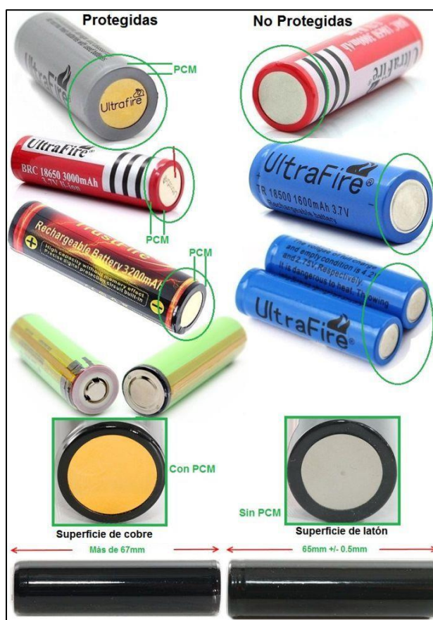
Figura 34. Tipos de Batería 18650
