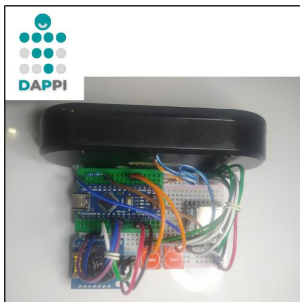
Figura 64. Conexión botones táctiles.
