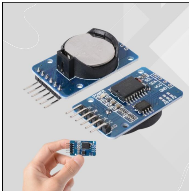
Figura 24. Funcionalidad y Tamaño Módulo RTC DS1307
