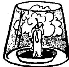
Figura 12.10 Neutralización del comburente.
