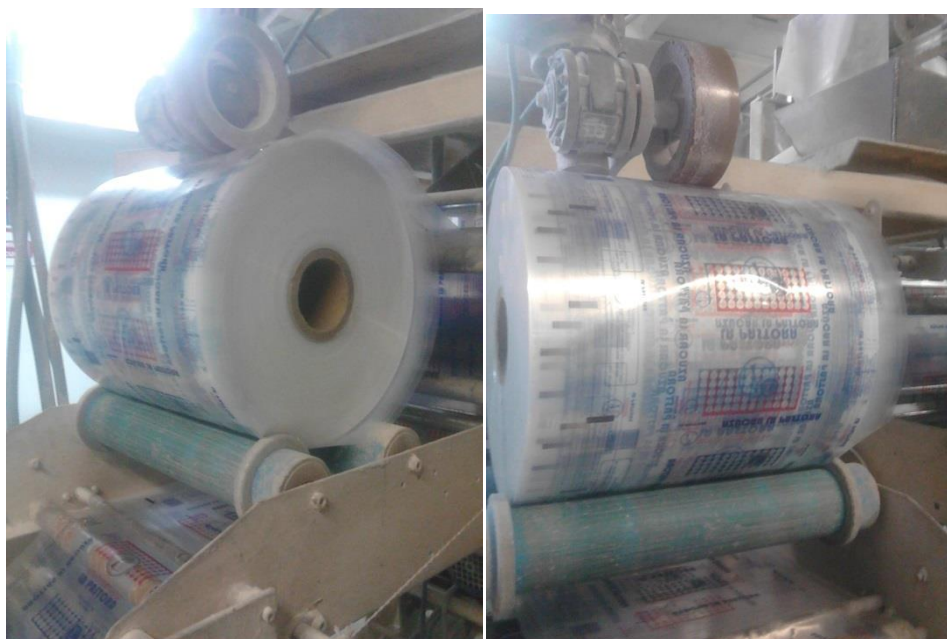
Foto N° 5, 6 Desplazamiento de material de envase de su estructura. Fuente. Colmenarez, Escalona (2019)
