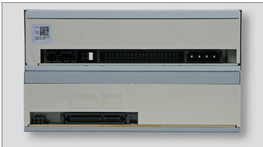
Figura 13. Parte trasera de dos unidades ópticas: la de arriba con tecnología IDE y la de abajo con tecnología SATA.
