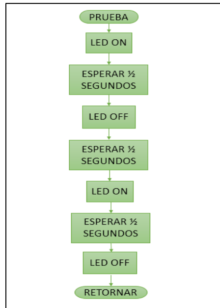
Figura 31: Diagrama de Flujo perteneciente a rutina interna en el funcionamiento del circuito
