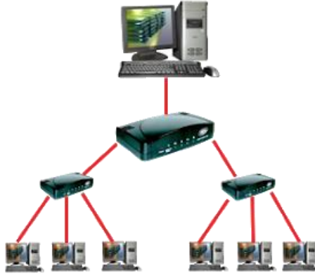
Figura N°4: Interconexión en árbol
