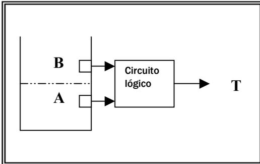
**Figura N° 3.13.1.1** Estanque con líquido a la mitad de él. A y B son sensores
