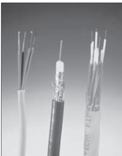
FIGURA 6.19 Los medios comunes de telecomunicaciones por guía: a) cable de par trenzado, b) cable coaxial, c) cable de fibra óptica.
