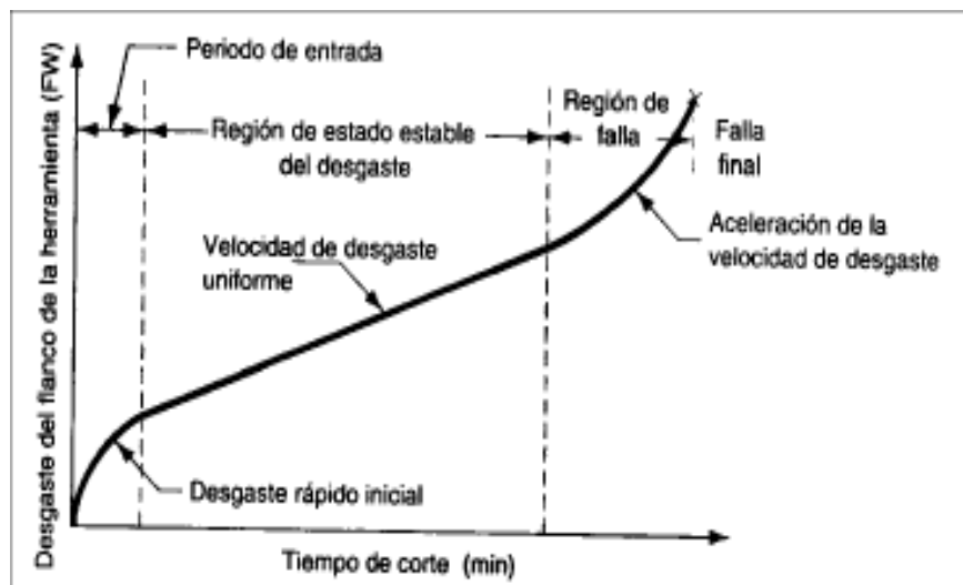
Figura 15 Desgaste de herramientas de corte
