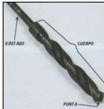
Figura 27 Partes de la broca
